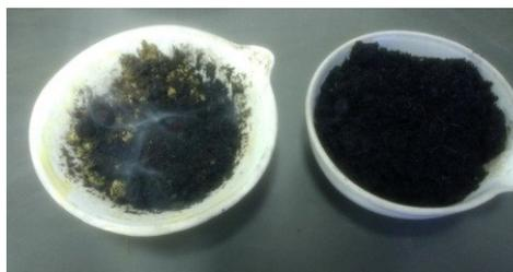
**Figura 1 – Carvão de bagaço de cana-de-açúcar antes (à esquerda) e após o processo de lavagem (à direita).**
